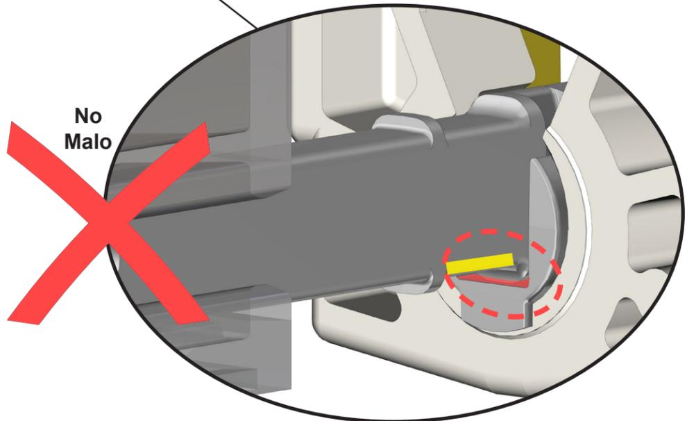
Necesita ser seguro que la seccion de la barra de pivote aqui en amarillo esta completamente abajo del cam. Los nudos de la cabeza T de la barra de pivote necesitan ser mas alla del cam en cada lado de la faja de ventana.
