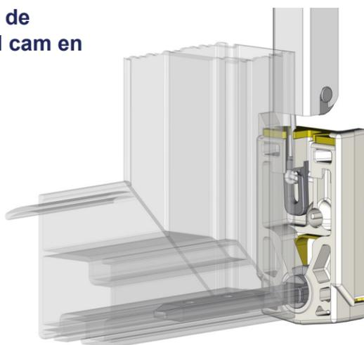
**NO PERMITAS** que la barra de pivote en cada lado de la faja de ventana sea instalada parcialmente y arriba del cam mientras que estas poniendo la faja en posicion. Puede resultar en la rotura del cam y el perdido de funcion de la ventana.
